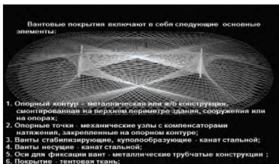
Рис. 2. Основные элементы вантовых покрытий
