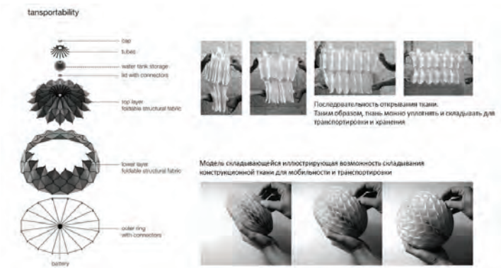
Рис. 19. Система складчатых конструкций и их транспортируемость [5]
