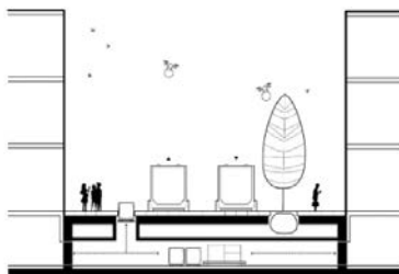
Рис. 8. Концепт автоматизированной системы подземной логистики под городскими улицами [4]
