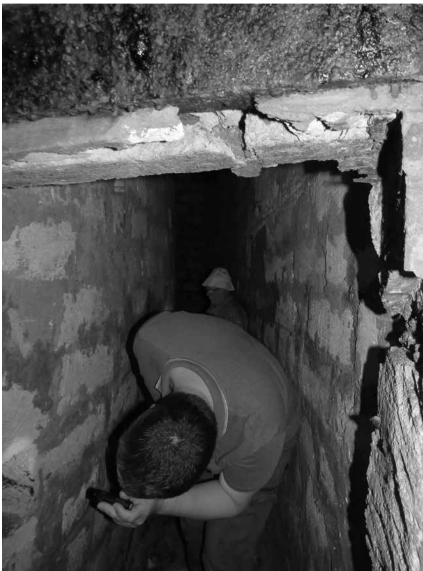
Рис. 3. Измерение параметров ТВР конструкций склепа сотрудником ГОСНИИР Н. Ю. Пинтелиным. Фото Н. Л. Кучеровской, 2019 г.
