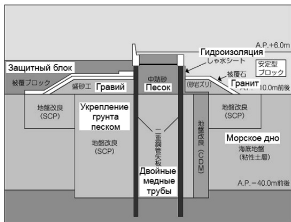
Рис. 5. Схема конструкции насыпных островов (5)
